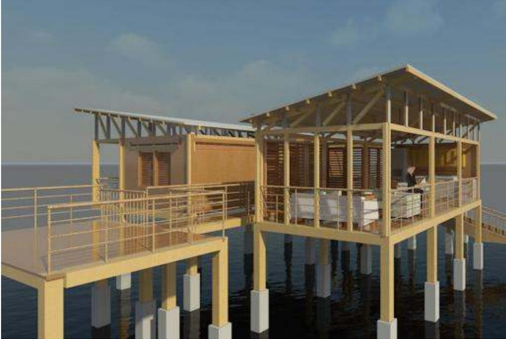
Figura 1: Esquema de construcción palafítica
