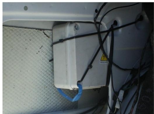
La conexión desde el EQ hacia los sensores de las puertas del vehículo se realiza a través del bulbo de la misma o mediante sensor magnético.
